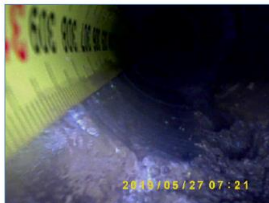
Immagine a 310 cm dalla fine del foro. Elementi lapidei e malta.
