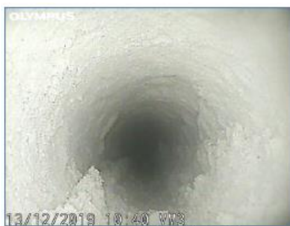
Immagine a 90 cm dall'inizio del foro. Elementi lapidei e malta.
