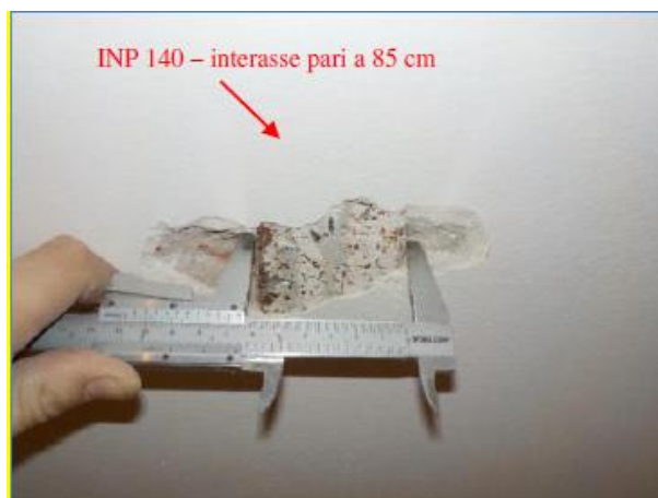
Indagine su solaio in acciaio
